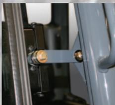
**BELÜFTUNG ▲** Die Türen der Fahrer-kabinen haben eine Verriegelung, mit der sie zwecks Belüftung teilweise geöffnet gehalten werden können.
